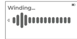
チューニング画面で ▶ を長押しすると巻き取り、◀ を押すと緩めます。離すとチューニングを再開します。
