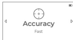
デフォルトではRoadie 4は高速チューニングに設定されています。日常使用には十分な速度と信頼性があります。録音時などより正確なチューニングが必要な場合は高精度モードに切り替えてください
