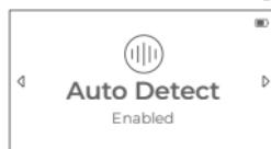
デフォルトでは、Roadie 4は一番低い弦から順番にチューニングします。Auto Detectが有効な場合、弾いた音を聴き、最も近い弦を自動的に選択してチューニングします。Roadieを任意のペグに置き、弦を弾くだけで音を識別します。細かい調整にはAuto Detectの使用を推奨します。
