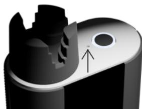
Inserta un alfiler en el agujero entre el botón de encendido y el conector de clavija. Oirás un clic y la pantalla se apagará.
